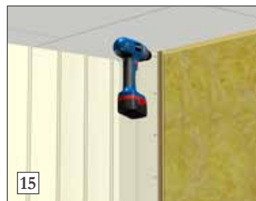
15) Platen skrues i spikerleppen. Inne i hjørnet festes platen synlig. Bunn og topp kan skrues på vanlig måte. Man bruker flikkmalingen (i org.fargen) til å male hodene på de synlige dykkstiftene. Bruk kosten som sitter i korken på flikkmalingsflasken
